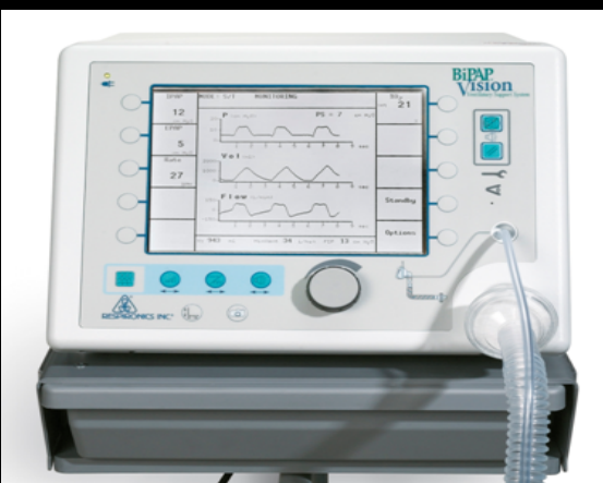
Parámetros ajustables en el ventilador de BIPAP: IPAP, EPAP, FR i FIO 2
